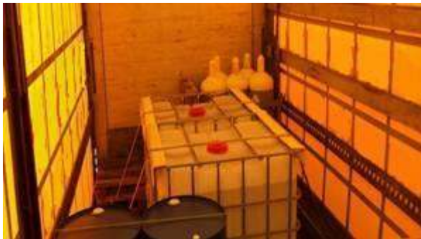
Kombination Form- und Kraftschluss in einer Kammer
