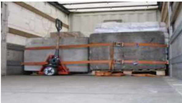
Kombination Form- und Kraftschluss Sicherung des Handhubwagens in Ladungssicherung integriert
