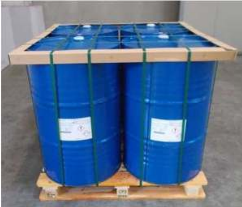
Ladeeinheitenbildung durch vertikale Bänderung von Stahlfässern
