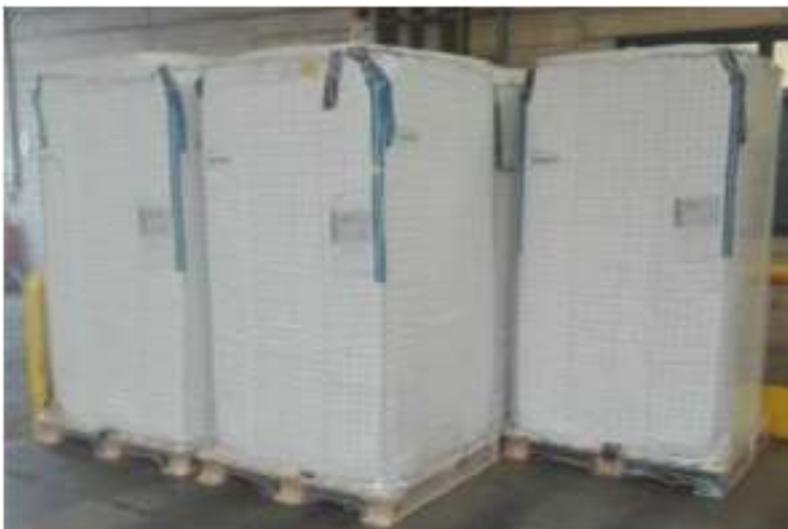
Ladeeinheitenbildung durch Schrumpfhauben über FIBC
