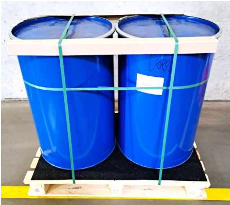
Ladeeinheitenbildung durch vertikale Bänderung von Stahlfässern CP2
