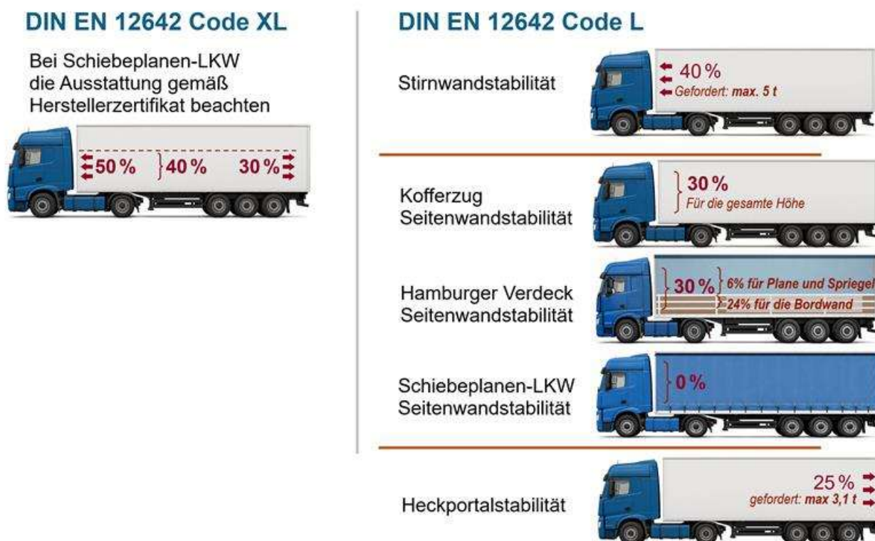
Abbildung 2 Rückhaltekräfte von Code XL und Code L Aufbauten im Vergleich
