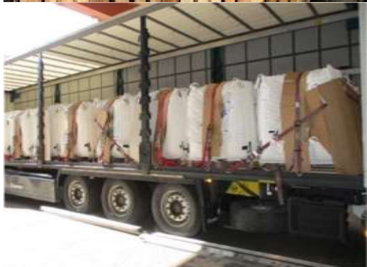
Gesamtansicht der gesicherten Ladung
