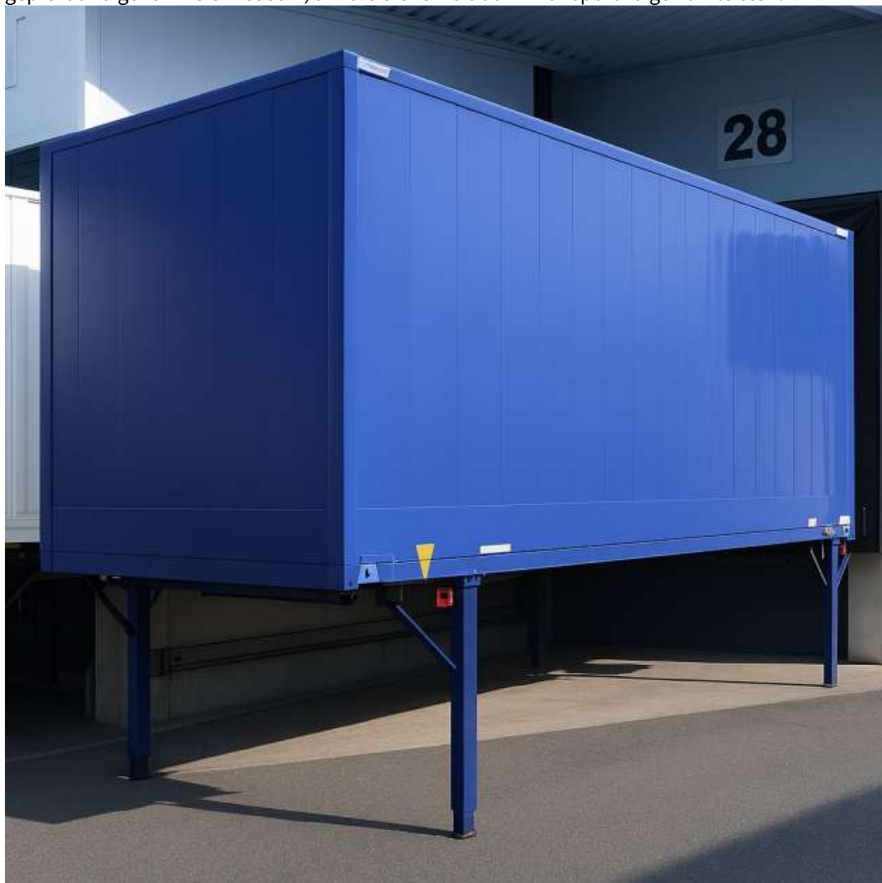
Abbildung 9: Wechselbrücke als Kofferaufbau – Außenansicht, Originalbild durch KI optimiert
