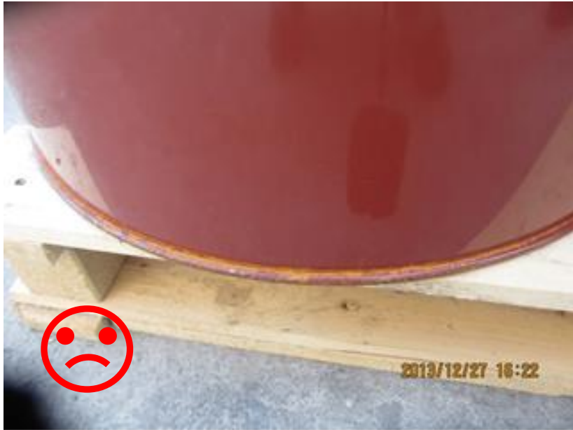
Rost im unteren Falz.
