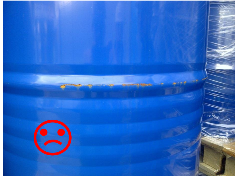
Rost an der Rollsicke mit deutlicher Volumenzunahme.
